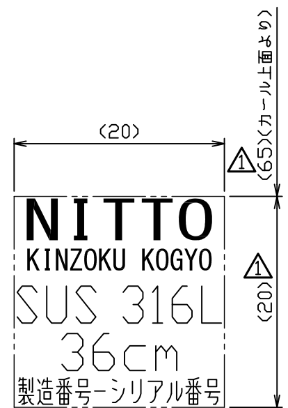
△レーザーマーク詳細図 S = 2 : 1
