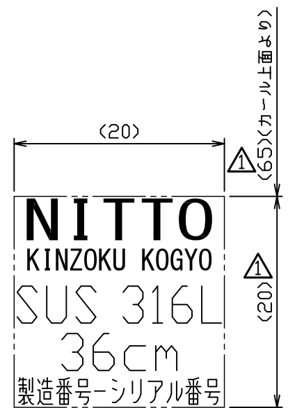
レーザーマーク詳細図 S = 2 : 1
