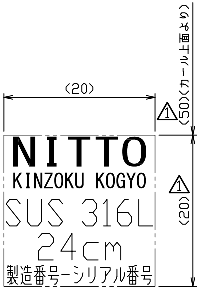
レーザーマーク詳細図 S = 2 : 1
