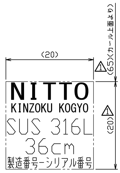
レーザーマーク詳細図 S = 2 : 1
